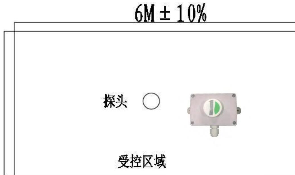
备注：检测到物体进入受控区域后，延时5秒，继电器开始输出（输出点是无源常开点），物体离开受控区域后，延时3秒，停止工作。探头安装在受控区域正中心离地面高度3米。探头盖开孔尺寸：长48mm, 宽10mm.
