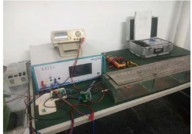
点脉冲群EFT测试
